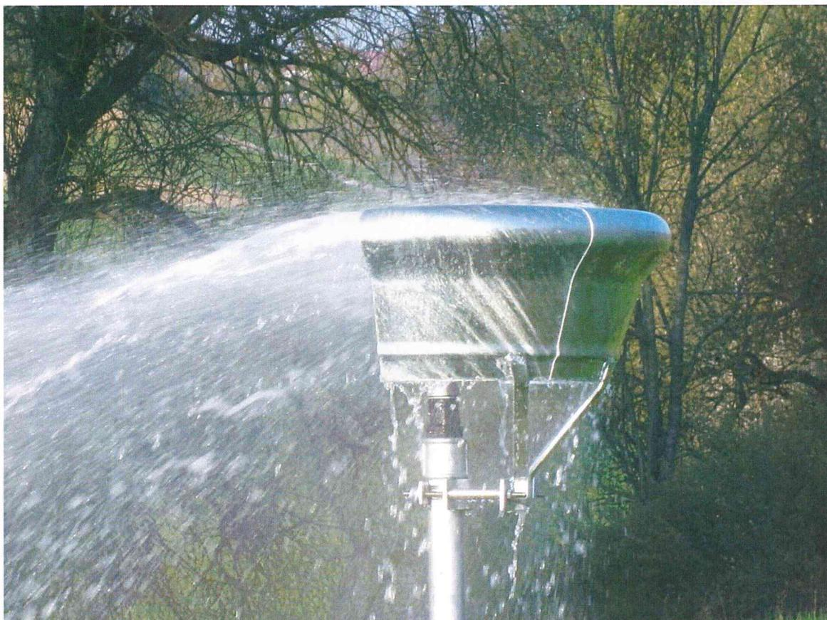
**Abbildung A7:**      **Wirkung der Blende bei hoher Beregnungsintensität (Nahaufnahme)**
