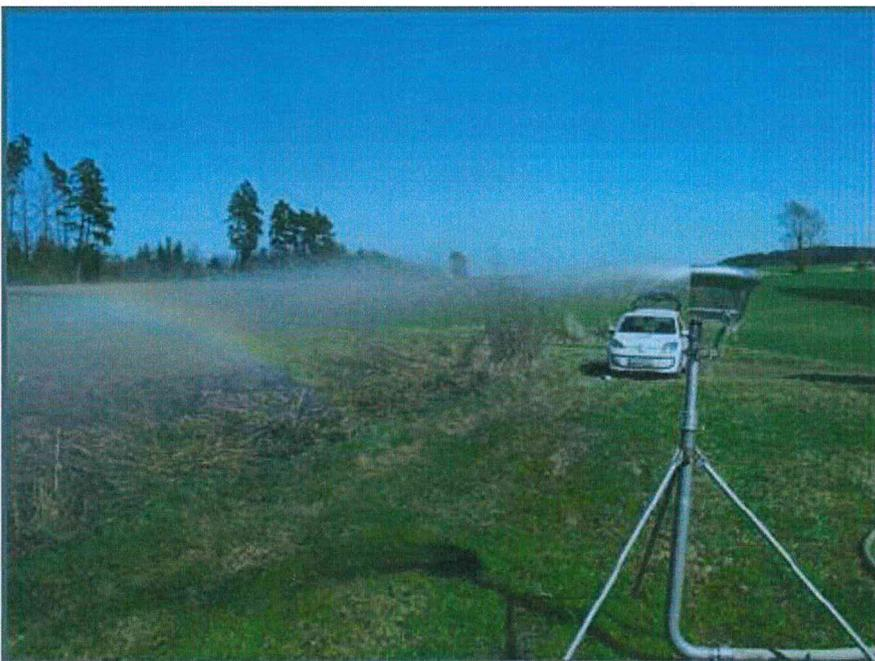
Abbildung 4: Regnerblende im Einsatz (Versuchsfeld bei Althengstett) bei Windstille
